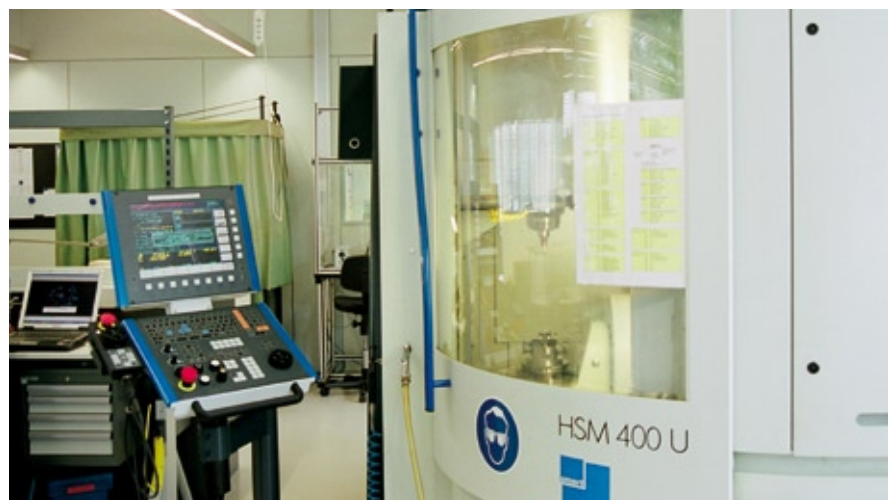
Die Gehäuse der IWC-Uhren entstehen u. a. auf diesem Mikron Bearbeitungszentrum.
