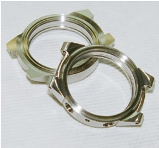
Fertig gefräste Gehäuse.
