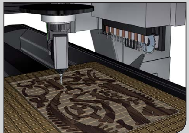
Beim Nesting werden die Bauteile platzsparend auf den vorher definierten Plattenmaßen verteilt, je nach Faserverlauf im Holz.
